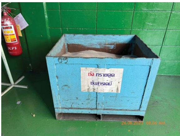
ภาพที่ 35 ทรายดูดขับสารเคมีหกั่วไหล
