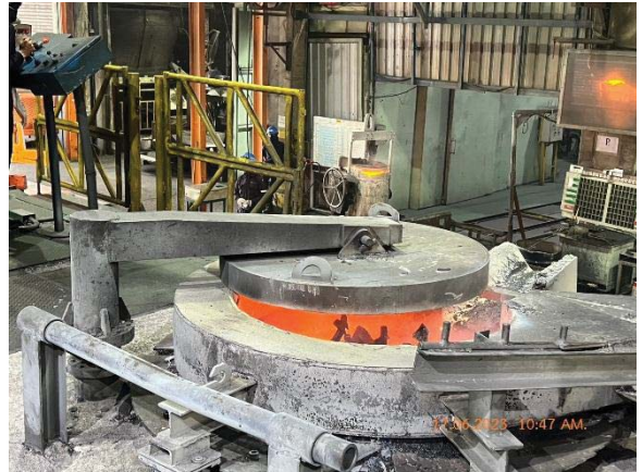
ภาพที่ 14 ระบบรวบรวมฝุ่น (ในขั้นตอนเติมแมกนีเซียมในเบ้าน้ำเหล็ก)
